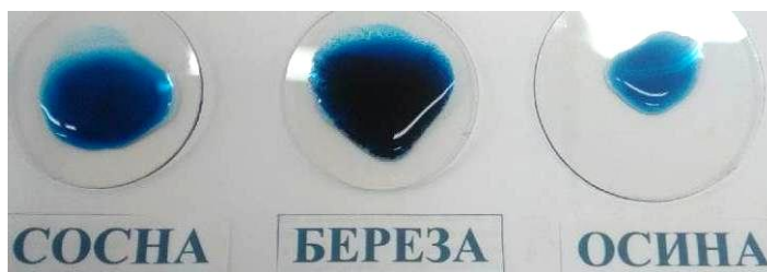
Фото №24,25. Солянокислая вытяжка с желтой кровяной солью. Эта реакция на катионы железа Fe^{3+} .
