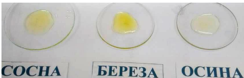
Фото № 29. Обнаружение фосфат-ионов нитратом серебра. Выпадение желтого осадка. В водной вытяжке.
