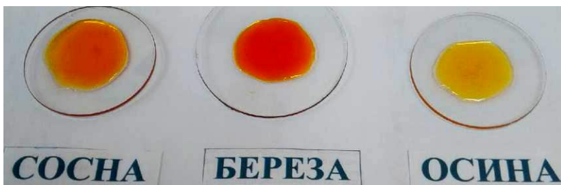
Фото № 30. Обнаружение фосфат-ионов роданидом железа. В солянокислой вытяжке.
