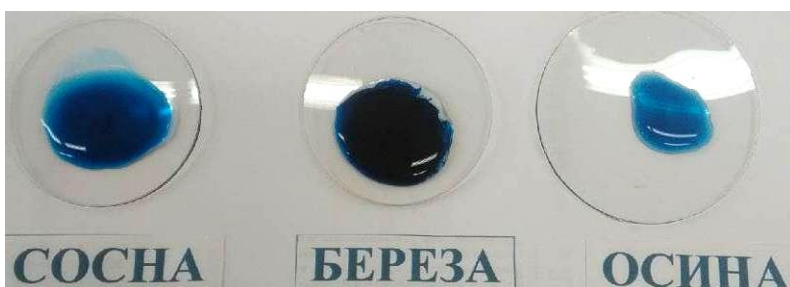
Фото №22,23. Солянокислая вытяжка с красной кровяной солью. Эта реакция на катионы железа Fe^{2+} .
