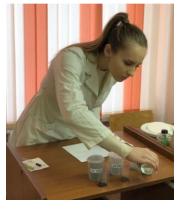
Фото №19-21. Получение солянокислой вытяжки. В золе сосны и березы было характерное "вскипание", что говорит о наличии карбонатов. При приливании к водной вытяжке соляной кислоты вскипание отсутствует, водорастворимые карбонаты не обнаружены.
