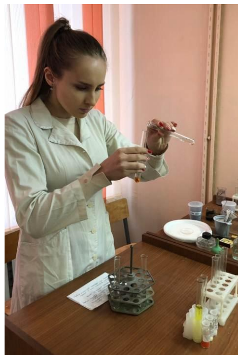
Фото №22,23. Солянокислая вытяжка с красной кровяной солью. Эта реакция на катионы железа Fe^{2+} .
