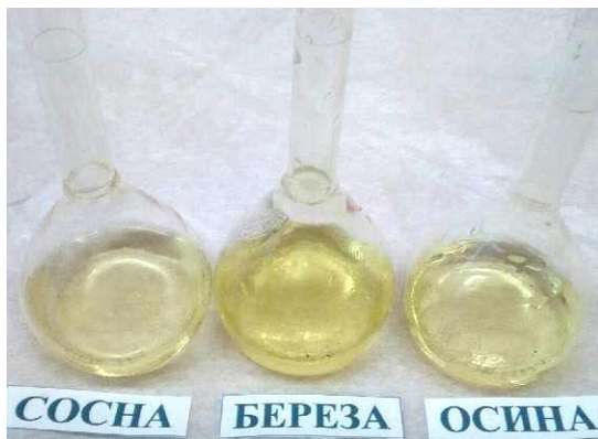
Фото №19-21. Получение солянокислой вытяжки. В золе сосны и березы было характерное "вскипание", что говорит о наличии карбонатов. При приливании к водной вытяжке соляной кислоты вскипание отсутствует, водорастворимые карбонаты не обнаружены.
