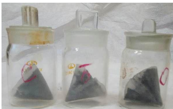
Фото №10-12. Фильтрация для определения растворимости золы сосны, березы, осины.
